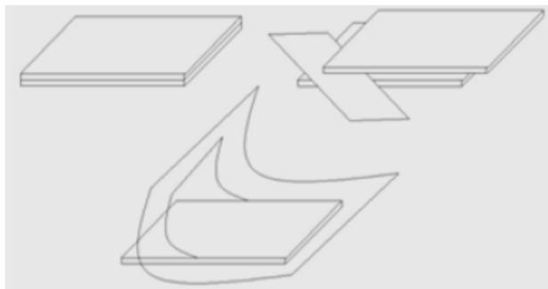
Figura 12.- Preparación de la superficie de mica.
