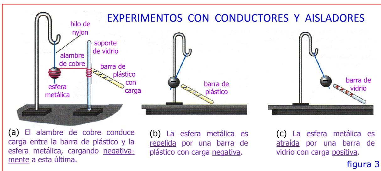
misma es atraída o repelida, lo que indica que ha adquirido carga eléctrica. Esta carga eléctrica se ha transferido por medio del alambre de cobre desde la superficie de la barra de plástico hasta la esfera.
