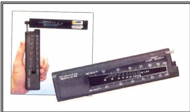
Psicrómetro de onda
