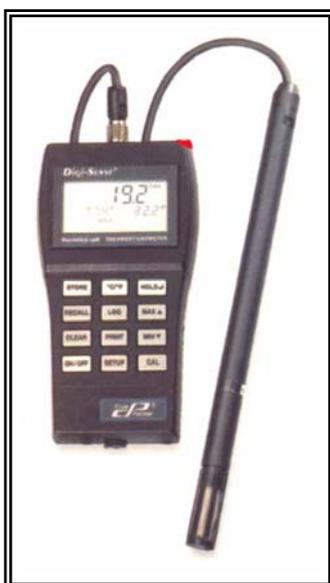
Psicrómetros que indican y almacenan datos de temperatura de bulbo húmedo, temperatura de rocío y HRA
