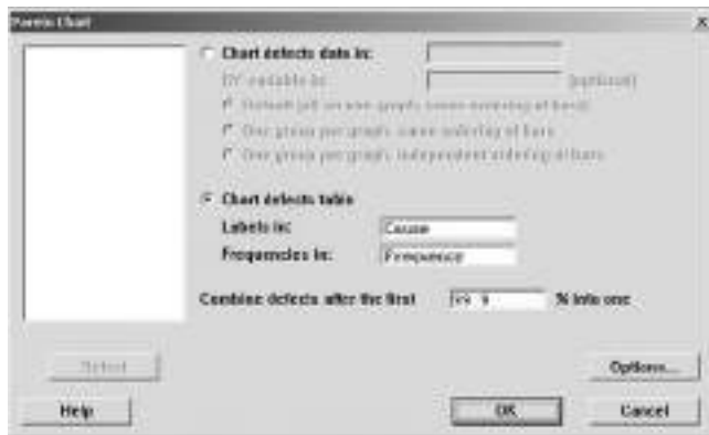
FIGURA A2.8 Ventana de diálogo para el diagrama de Pareto en Minitab.
