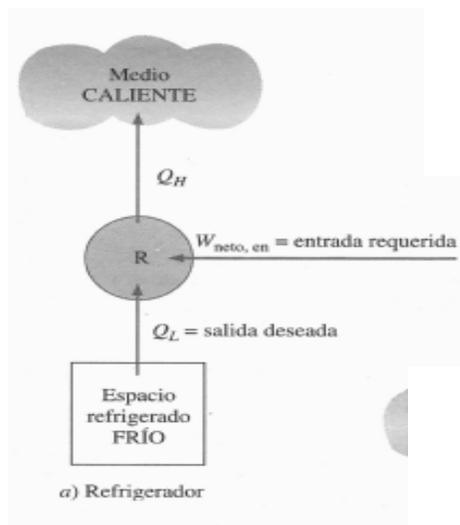
(fig 2-a): Esquema de sistema de refrigeración.
