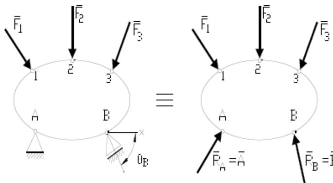
En el apoyo fijo se originará una reacción pasante por dicho punto (la descomposición de  $R_{Ax}$  y  $R_{Ay}$ ), y en el apoyo móvil la reacción pasará por el punto y será normal a la dirección del plano de deslizamiento ( $R_B$ ).
