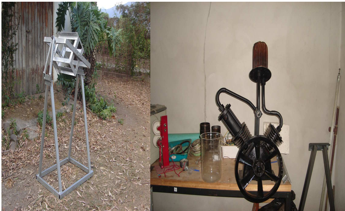
Figura 8: Izquierda montaje articulado, derecha el motor stirling.
