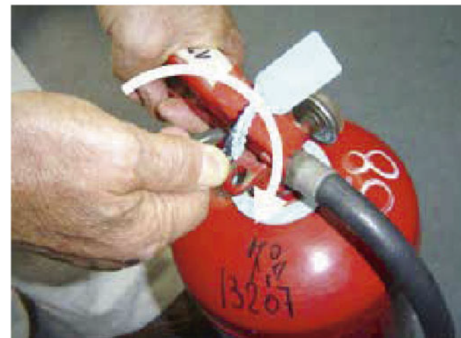
Al girar la clavija hacia adelante, tal como lo muestra la foto, se corta el precinto y puede retirarse el seguro.
