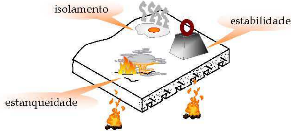
Figura 9: Propiedades de resistencia al fuego de elementos de compartimentación (losas, paredes, puertas cortafuego) Isolamento = aislación estanqueidade = estanqueidad estabilidade = estabilidad
