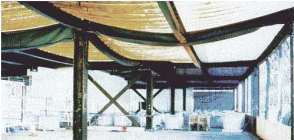
Figura 34 – Aspecto final después de uno de los incendios experimentales en Cardington Foto SCI
