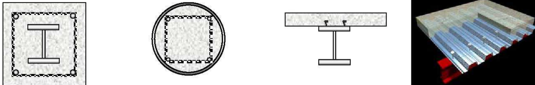
Figura 16: Estructuras mixtas de acero y concreto
