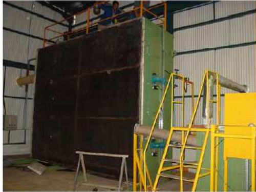
Figura 30 – Horno para ensayos a altas temperaturas – Furnas (Goiânia – Brasil) Foto del autor
