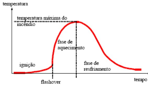
Figura 10: Curva de temperatura-tempo de um incêndio real Temperature maxima do incendio = Temperatura máxima del incendio Fase de aquecimento = Fase de calentamiento Ignição = Ignición Fase de resfriamento = Fase de enfriamiento Tempo = Tiempo
