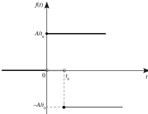
Figura B.7: Funciones escalón unitaria  $H(t)$  y escalón unitaria desplazada  $H(t-t_0)$ . Donde, la suma algebraica de ambas funciones escalón dan como resultado la función pulso representada en la Fig. B.6.
