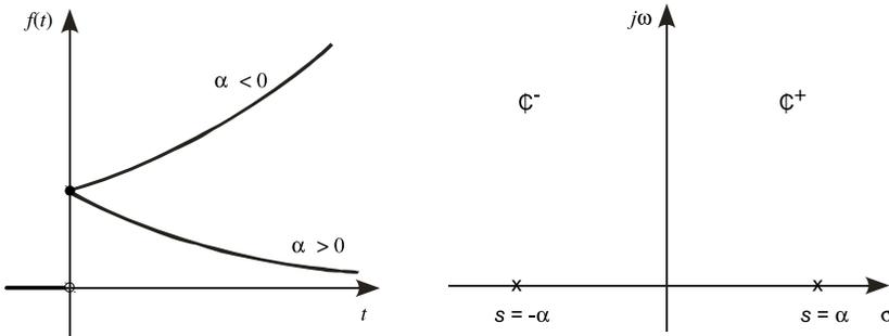
Figura B.3: a) Representación gráfica de la función  $f(t)$  en el tiempo. b) Ubicación del polo de la función de transferencia  $F(s)$  para  $\alpha < 0$  y  $\alpha > 0$ .
