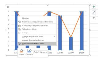
Cambiar el ancho de rango al 0%, de esa manera se conseguirá el ancho del intervalo correspondiente,
