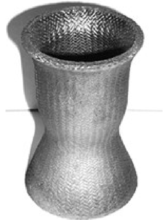
Cámara de combustión hecha de Cf-HfC.
