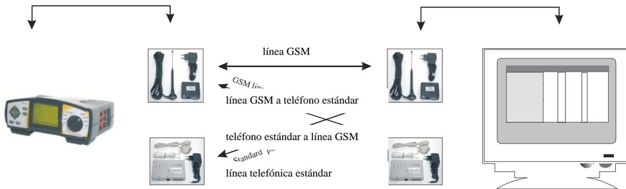
Conexión del MÓDEM, el INSTRUMENTO y el PC
