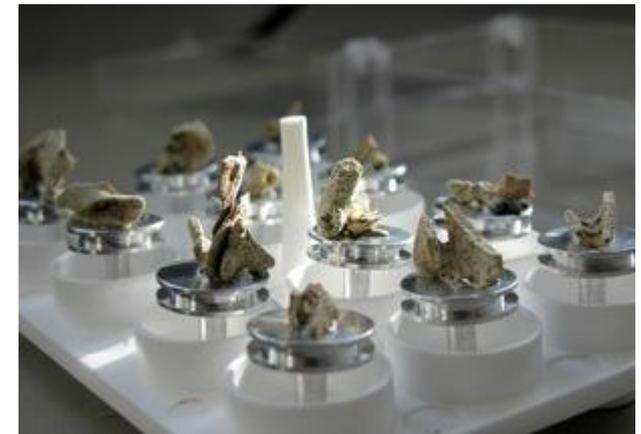
*Muestras ya recubiertas con una película metálica*
