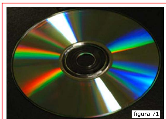
LOS SURCOS MICROSCÓPICOS DE LA SUPERFICIE DE ESTE CD ACTÚAN COMO UNA REJILLA DE DIFRACCIÓN Y DIVIDEN LA LUZ BLANCA EN LOS COLORES QUE LA COMPONEN. LA SEPARACIÓN ENTRE SURCOS ES DE  $1,6 \mu\text{m}$ , LO CUAL REPRESENTA 625 RENDIJAS/mm.
