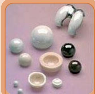
**Imagen 40.** Distintos tipos de cabeza de fémur construida con alúmina
