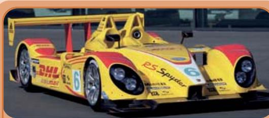
**Imagen 54.** Carrocería de automóvil de competición fabricada con fibra aramídica Kevlar
