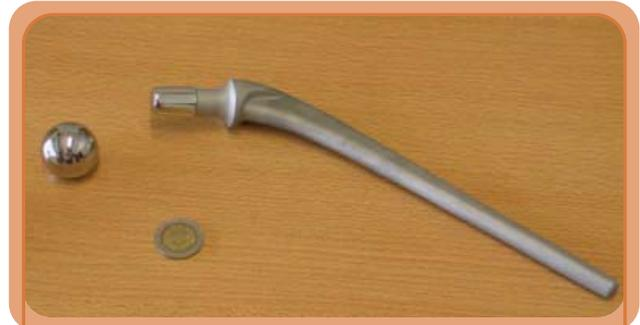
**Imagen 6.** Componentes metálicos de un implante total de cadera fabricados en aleación titanio-aluminio-vanadio
