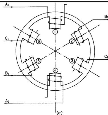
La figura (a) representa un estator con sus tres bobinas formando un bobinado trifásico de dos polos. Estas bobinas se identifican como A, B, C.
