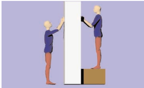
Figura 88 - Trabajar sobre una plataforma para evitar alcances alejados.
