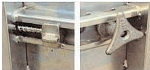
Figura 60 - Sistemas de apertura de los paneles de encofrar.
