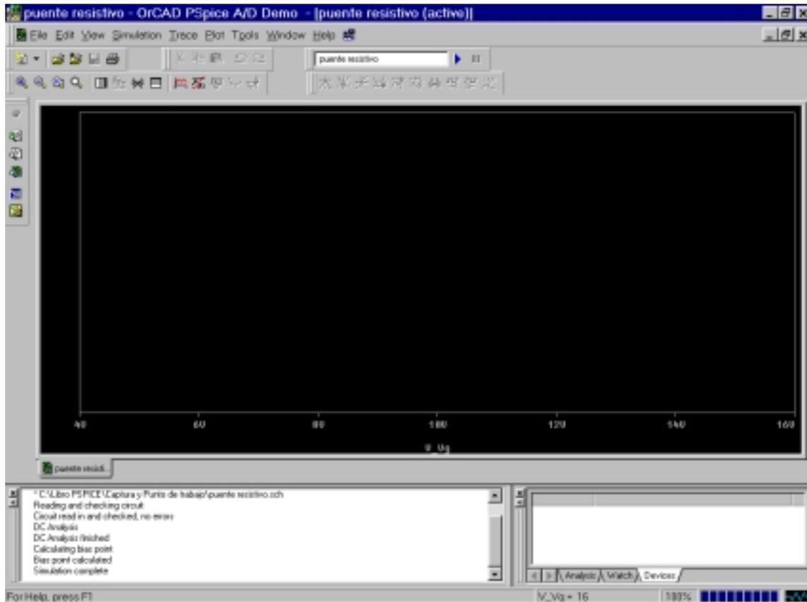
En el eje de ordenadas podemos definir cualquier corriente o tensión del circuito para así ver cómo varía en función de  $V_g$ . La forma de definir una corriente o tensión es a través del menú “Trace” en el que seleccionamos la opción Añadir.
