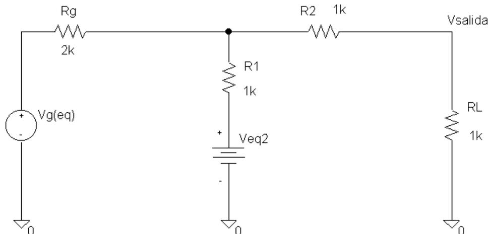
Mediante las transformaciones de Thévenin a Norton y viceversa y la movilidad de los generadores demuestre la igualdad de ambos circuitos. Calcule el valor de  $V_{eq2}$  y la expresión de  $V_g(eq)$  para la variación de  $V_g$  descrita anteriormente (de  $-10$  Voltios a  $+10$  voltios)
