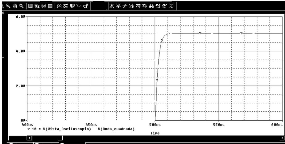
Hay otro procedimiento de ampliar una zona de pantalla y es definiendo dos vértices opuestos de dicha zona mediante el ratón. Se hace un clic, se arrastra y se hace un segundo clic. Tras seleccionar en “View” la opción “Area”, la gráfica se ajusta al área seleccionada.
