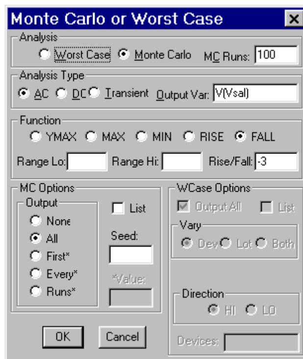
El primero de ellos permite obtener muestras aleatorias del comportamiento del circuito al variar aleatoriamente el valor de los parámetros debido a las tolerancias.
