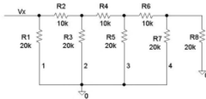
Abra el circuito en el punto señalado con “1” e introduzca un generador de tensión de 10 Voltios. Analícelo y anote la tensión en Vx.
