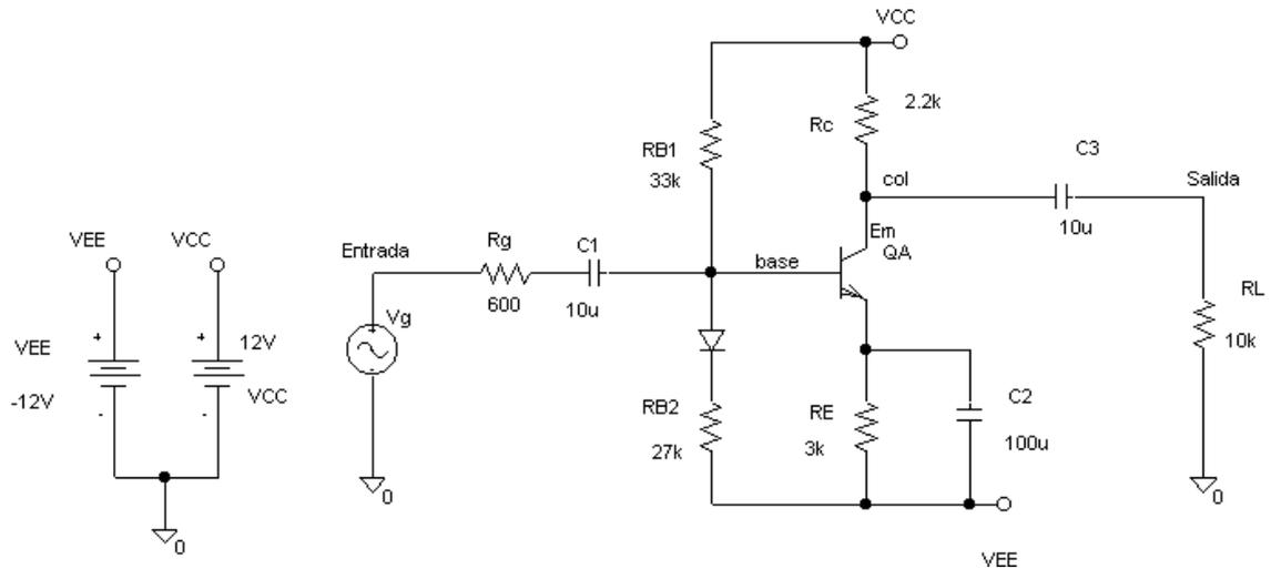
Este amplificador es capaz de producir mucha ganancia, sin embargo también produce una distorsión apreciable si la amplitud de la señal de salida es relativamente grande. En este ejemplo se ha exagerado el error introduciendo una señal  $V_g$  de 50 milivoltios de amplitud y 1 KHz.
