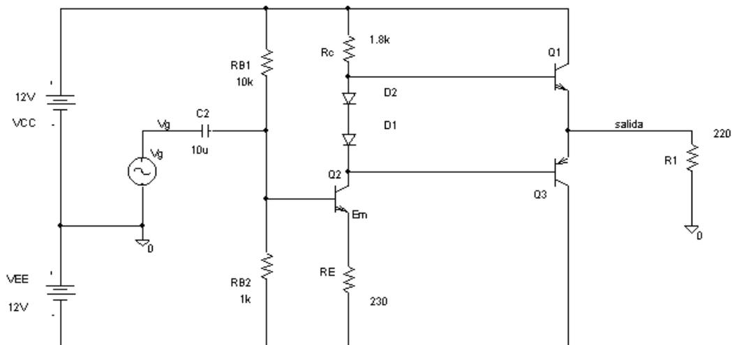
Analice el circuito y calcule el valor de los armónicos en la salida para las siguientes valores de la señal de entrada:
