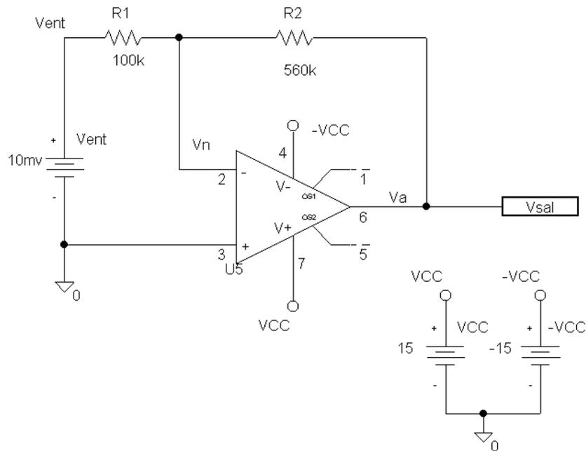
La tolerancia de las resistencias será del 5%, la del parámetro “ $I_s$ ” del 25% y “ $\beta$ ” del 50%.
