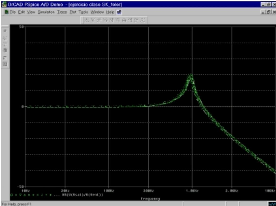
Para conocer más exactamente las probabilidades de que el filtro diseñado este dentro de especificaciones se puede hacer uso de una herramienta estadística que dispone el analizador de ondas.
