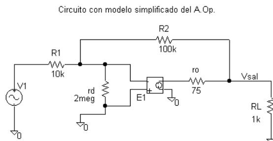
Este modelo del amplificador operacional es válido para aplicaciones en las que el amplificador operacional se puede suponer ideal, por ejemplo cuando trabaja como amplificador inversor de ganancia -10.
