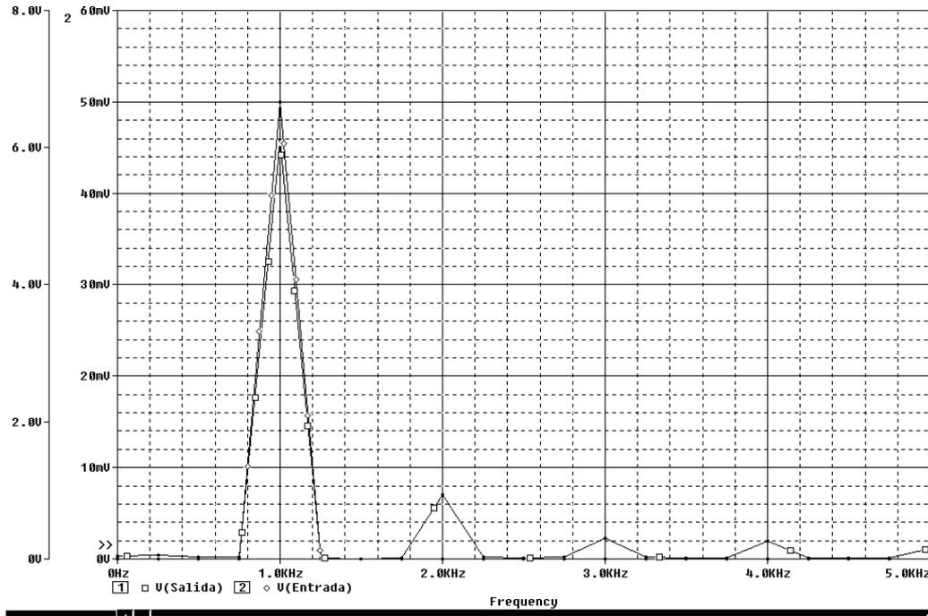
El analizador nos muestra las componentes de frecuencia de las señales en pantalla. Para la señal de entrada, lógicamente solo hay una componente a 1 KHz., pero para la señal de salida hay componentes para todos los armónicos representados.
