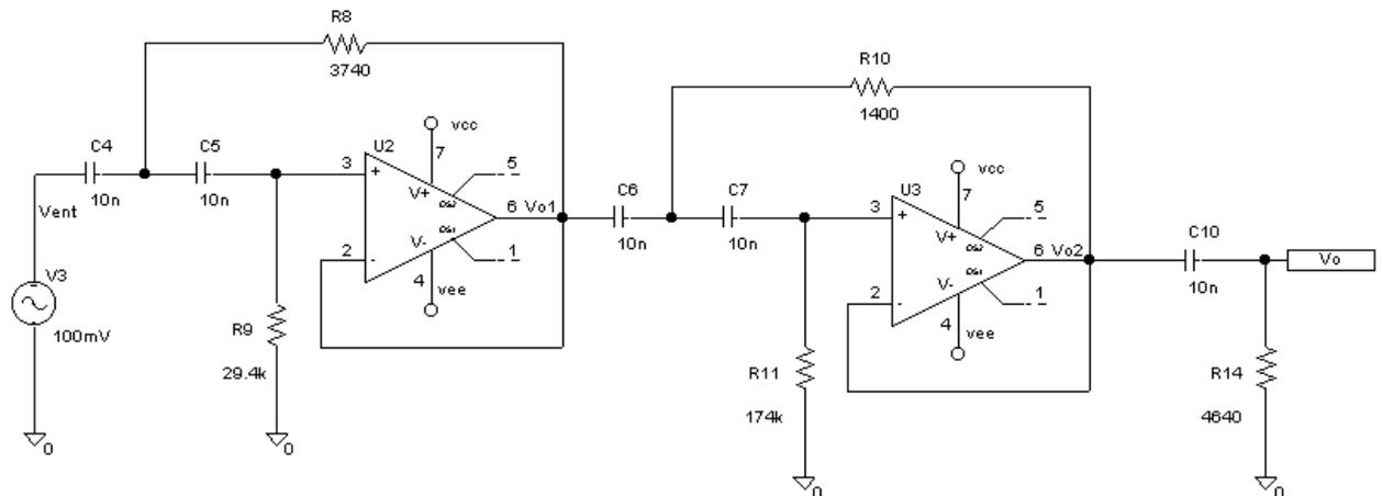
Vamos a analizar su respuesta en frecuencia en el rango de 100 Hz a 100 KHz, por tanto habrá que dar un valor al campo “AC” del generador de la entrada. El valor dado es la amplitud de la señal y en este caso le damos el valor de 100 milivoltios.
