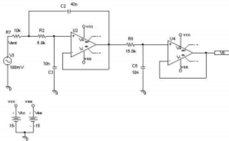
y analice su comportamiento con el fin de determinar su ganancia en la banda de paso, el Q del circuito y su frecuencia de corte.
