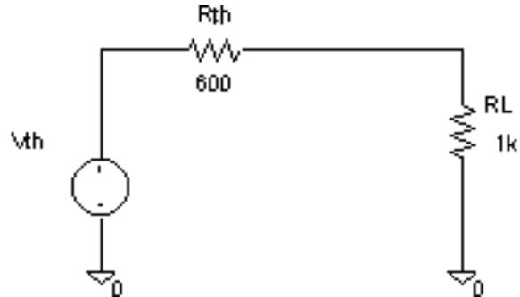
Obtenga el valor de la resistencia equivalente y la expresión del generador equivalente. Capture el nuevo circuito y analice de nuevo obteniendo la variación de la tensión en bornas de RL para la variación de Vg descrita anteriormente (entre -10 y + 10 Voltios).
