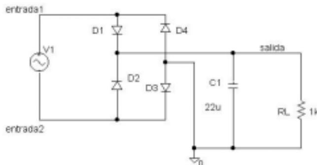
Analice el circuito y mida el valor de la tensión de salida para diferentes amplitudes de la tensión de entrada. En estos circuitos se producen unos transitorios, lo cual debe tener en cuenta a la hora de definir los parámetros : “No Print Delay” y “Final Time”
