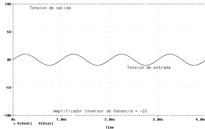
La utilización de este subcircuito del amplificador operacional también puede traer problemas dado que con este modelo no se aprecian limitaciones importantes del operacional real como es por ejemplo, su limitación de la máxima amplitud de la tensión de salida.
