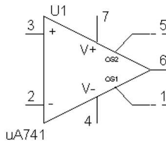
Es frecuente representar la borna inversora arriba y la no inversora abajo por lo cual vamos a girar y voltear el operacional. En el menú edit se elige Rotar y después “Voltear” que equivale a girar el componente según un eje de simetría.
