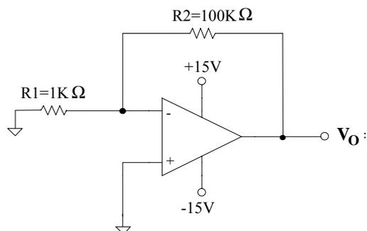
Con las medidas obtenidas obtenga el valor de los parámetros  $I_B$ ,  $I_{IO}$  y  $V_{OS}$  del modelo de PSPICE del uA741.
