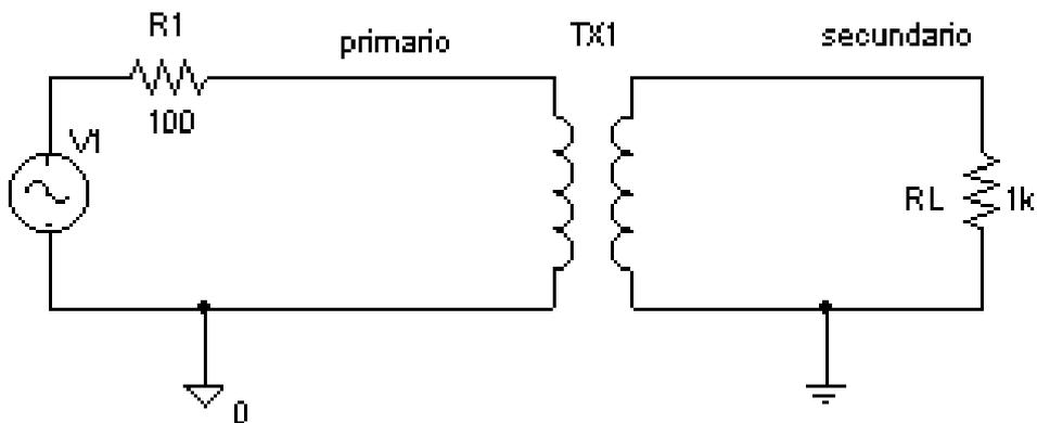
Analice el circuito para varios valores de los parámetros del transformador y diseñe un circuito que a partir de una señal sinusoidal de 1 voltio de amplitud se generen dos señales sinusoidales en oposición de fase de 2 voltios de amplitud cada una. Para ambas señales la resistencia de carga será de 1 Kilohmio.
