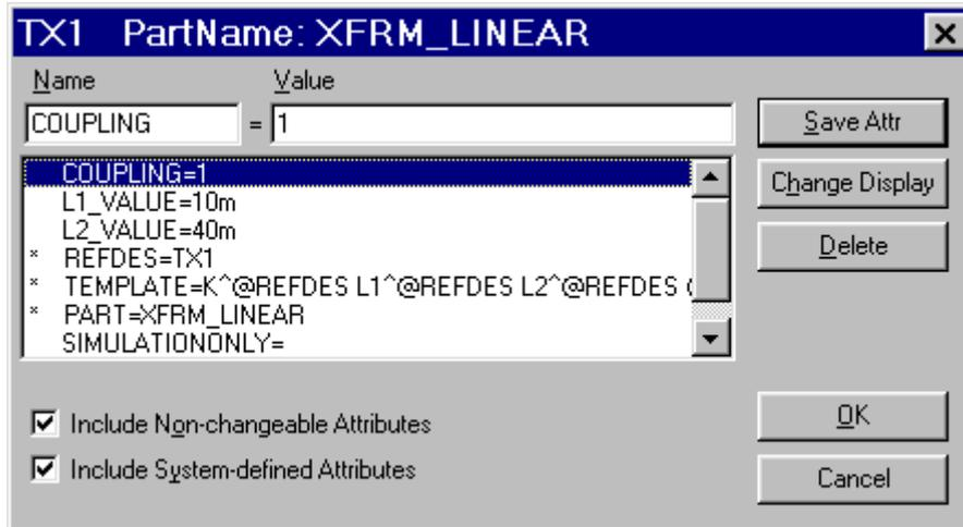
Coupling: Factor de acoplamiento que debe estar en el rango de  $-1$  a  $+1$ .
