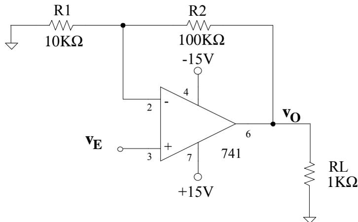
**Margen dinámico con  $V_{CC} = \pm 15V$ .**
