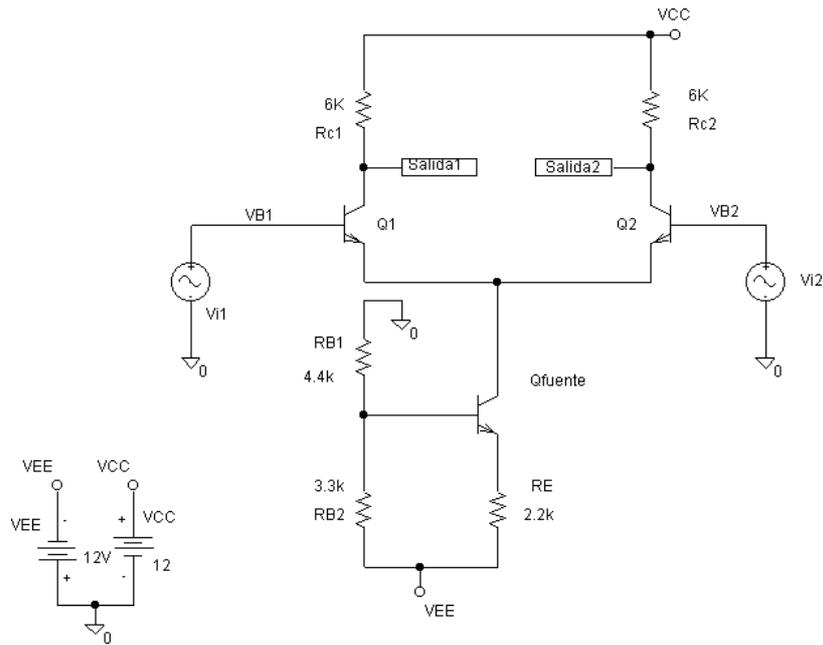
Suponga que las resistencias tienen una tolerancia del 5% y que los transistores de entrada tienen una tolerancia en los parámetros “ $I_s$ ” del 25% y “ $\beta$ ” del 50%.
