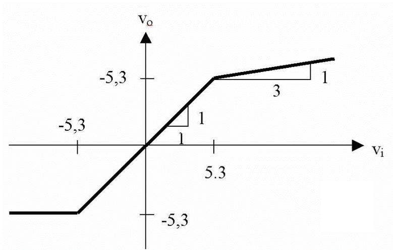
Capture y simule con PSpice el circuito diseñado para comprobar su correcto funcionamiento. Para ello aplique una tensión de entrada sinusoidal de amplitud 20 V y frecuencia 1 kHz. Represente la función de transferencia del circuito (variación de la tensión de salida en función de la tensión de entrada).
