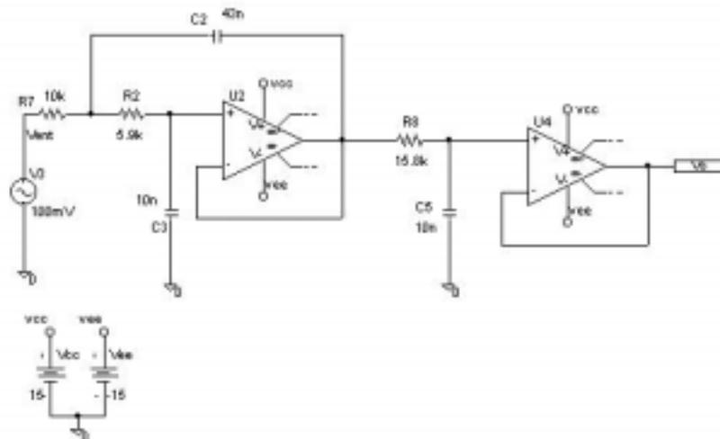
En este caso se debe introducir una señal que simule la salida del convertidor. Para ello elimine el generador sinusoidal V3 e introduzca dos generadores de pulso con los cuales debe construir la señal de entrada que se muestra a continuación:
