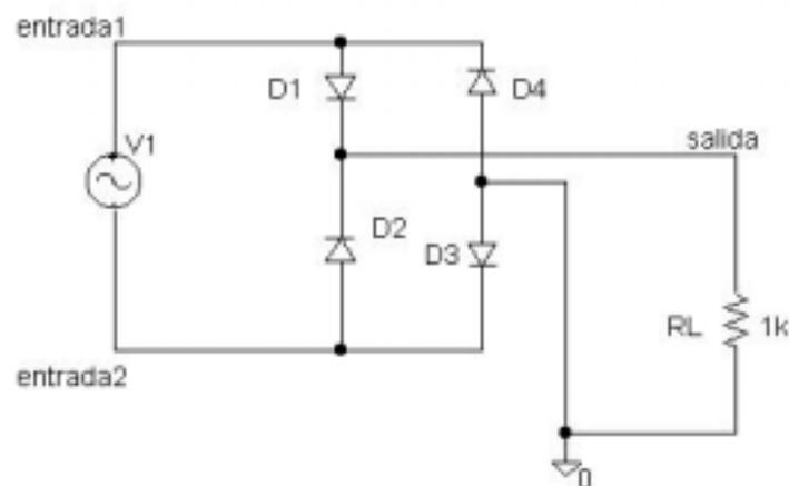
Analice el circuito y compruebe la función que realiza el puente de diodos.
