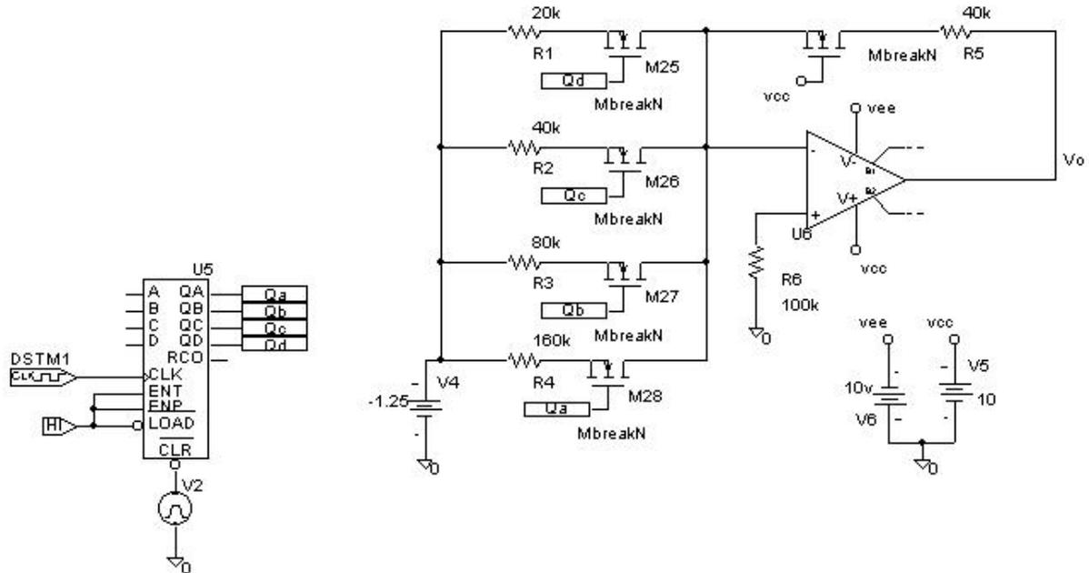
Para los transistores MOST utilice MbreakN de la librería “BREAKOUT” y para el operacional utilice por ejemplo el “LM324” de la librería “EVAL”.
