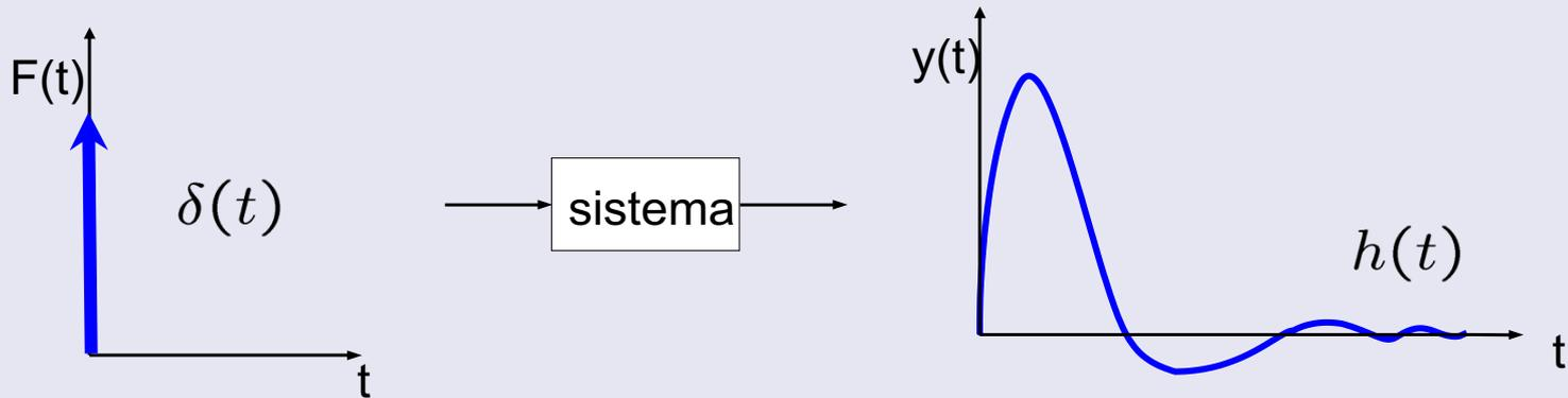
**Respuesta impulsional:** es la salida que se produce en un sistema cuando se aplica en su entrada un impulso unitario
