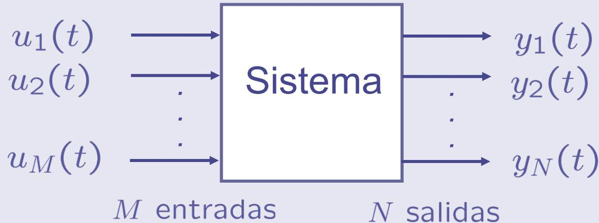
Sea  $h_{ij}(t)$  la respuesta de la salida  $y_i(t)$  ante un impulso en  $u_j(t)$  (con el resto de entradas nulas)
