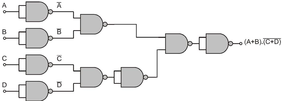
En los ejemplos anteriores se puede observar que una de las alternativas (**NAND** o **NOR**) requiere menor cantidad de compuertas. En algunos casos el circuito mas reducido resultará con compuertas **NAND**, y en otros casos con compuertas **NOR**. En la práctica se trata de implementar un circuito con la menor cantidad de compuertas posibles, por dos razones importantes:
