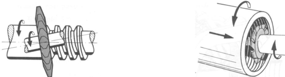
**ROSCADO CON FRESA MADRE:** el roscado se realiza en una sola vuelta de la pieza con ayuda de una fresa de forma cuyos dientes reproducen los vanos entre los filetes de la rosca. Se utiliza para obtener roscas interiores y exteriores de pequeña longitud situadas en los extremos de las piezas.
