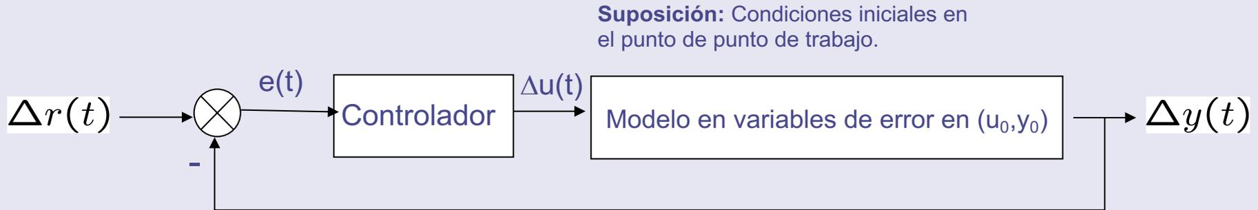
Análisis de la respuesta del sistema linealizado en lazo cerrado. Tanto el sistema linealizado y controlador son sistemas lineales.
