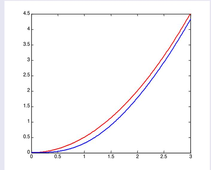
Error en aceleración acotado  $\Leftrightarrow$  Error en posición nulo  $\Leftrightarrow$  Error en velocidad nulo (C(s)G(s) tiene al menos dos integradores)
