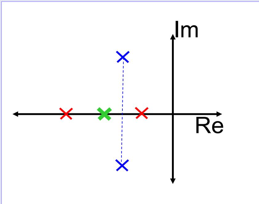
$$\left\{ \begin{array}{l} \delta > 1: \text{ Sobreamortiguado} \\ \delta = 1: \text{ Críticamente amort.} \\ \delta < 1: \text{ Subamortiguado.} \end{array} \right.$$
