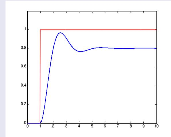
Todo sistema estable tiene error en posición acotado
