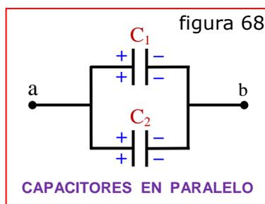
Si dos capacitores están conectados EN PARALELO como en la figura 68, la diferencia de potencial entre las placas de cada capacitor es la misma y la carga total desplazada es la suma de las cargas individuales. Por consiguiente:
