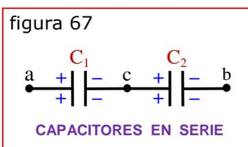
Supongamos dos condensadores de capacidades  $C_1$  y  $C_2$  conectados **EN SERIE** como en la **figura 67**, donde se mantienen los terminales **a** y **b** a una diferencia de potencial  $V_{ab}$ . Se tiene:
