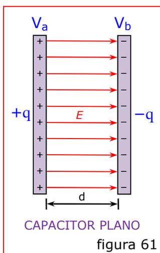
Supongamos en primer lugar que las placas se encuentran en el vacío. Hemos demostrado que la intensidad del campo eléctrico entre un par de láminas paralelas muy próximas y en el vacío es:
