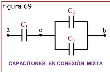
La figura 69 representa una red sencilla de capacitores conectados en serie y en paralelo. Primero obtenemos la capacidad equivalente  $C_{23}$  de los dos capacitores en paralelo:  $C_{23} = C_2 + C_3$ . Luego, para hallar la capacidad equivalente total  $C_T$ , consideramos la serie resultante:  $1/C_T = (1/C_1) + (1/C_{23})$ .
