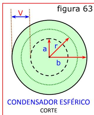
Consideremos dos cáscaras conductoras esféricas y concéntricas de radios  $a$  y  $b$  (figura 63), que poseen cargas iguales y opuestas  $+q$  y  $-q$ . Tomemos como *superficie gaussiana* una esfera de radio  $r$  entre las dos esferas y concéntrica con ellas. Sabemos que el flujo eléctrico a través de esta superficie está dado por la ecuación:
