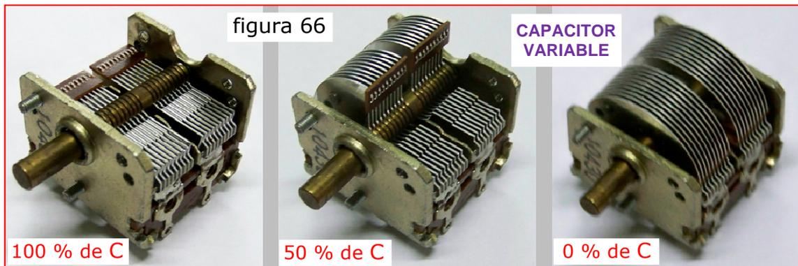
formados por cierto número de láminas metálicas paralelas y fijas, conectadas entre sí, que constituyen una de las armaduras del condensador, mientras que un segundo conjunto de placas móviles también conectadas entre sí forman la otra armadura. Un capacitor variable se representa por el símbolo  $\rightarrow\text{---}|$
