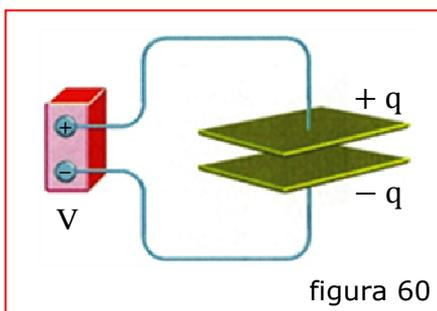
Un caso especial importante se presenta en la práctica cuando *dos conductores próximos reciben cargas del mismo valor y signo contrario*. Esto se consigue corrientemente conectando ambos conductores, descargados inicialmente, a los bornes de una batería eléctrica, lo que ocasiona el paso de carga de un conductor al otro (figura 60). Este
