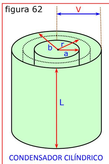
zamiento sólo cortan a esta superficie a través de la superficie curva de área  $2\pi rL$ . Representando por  $D$  el desplazamiento a la distancia  $r$  del eje, se tiene:
