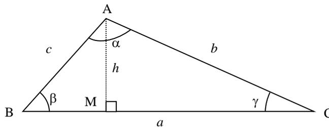
Trazamos la altura correspondiente a un vértice, por ejemplo al vértice A, y sea  $h$  la longitud de esta altura. Analizando los dos triángulos rectángulos producidos: el AMB y el AMC tenemos lo siguiente:
