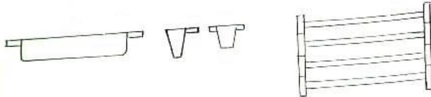
Las parrillas mecánicas pueden ser giratorias o estar constituidas por una cinta horizontal móvil. Cualquiera sea el tipo de parrilla, se limita el extremo opuesto a la carga con una pared de material refractario denominado ALTAR.
