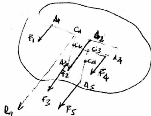
Al cual se le aplican las fuerzas paralelas  $F_1, F_2, \dots, F_n$ .  $F_1$  y  $F_2$  son reemplazadas por su resultante  $R_1$ , aplicado en  $C_1$  situado sobre la recta de acción  $A_1 A_2$ , de manera tal que se cumpla la relación
