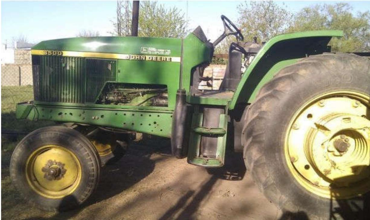
CONSISTE EN DOS LATERALES DE CHAPA PLEGADA REFORZADAS Y SOPORTES TRANSVERSALES DONDE SE MONTAN EL TREN DELANTERO, MOTOR, CAJA DE TRANSMISIÓN Y EMBRAGUE, DIFERENCIAL, MANDOS FINALES Y PLATAFORMA DE OPERACIÓN, SE UTILIZAN EN TRACTORES DE MEDIANA POTENCIA.
