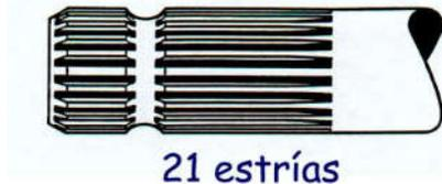
1000 RPM: SE UTILIZA PARA BAJOS ESFUERZOS Y ALTAS REVOLUCIONES
