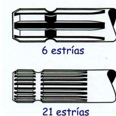
540 RPM: SE UTILIZA PARA ELEVADOS ESFUERZOS Y BAJAS REVOLUCIONES.
