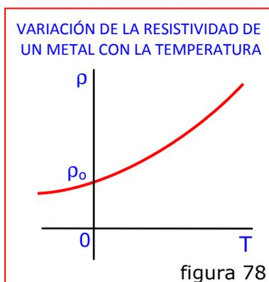
78 muestra una gráfica de la resistividad en función de la temperatura, para un conductor metálico. La curva puede representarse satisfactoriamente por una ecuación de la forma  $\rho = \rho_0 + a(T - T_0) + b(T - T_0)^2 + \dots$ , siendo:  $\rho$  la resistividad a la temperatura  $T$ ,  $\rho_0$  la resistividad a la temperatura de referencia  $T_0$  y  $a, b$ , etc., constantes características de cada sustancia. Para temperaturas no demasiado grandes y dentro de un intervalo de  $\pm 100$  °C
