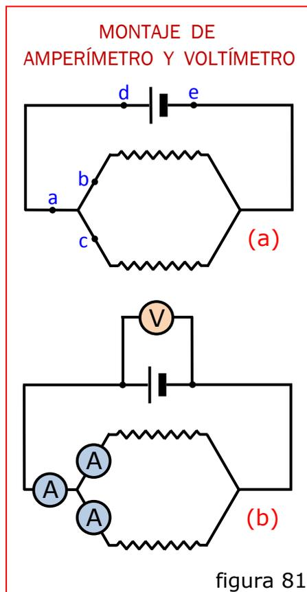
Para medir la intensidad de una corriente en puntos tales como *a*, *b* y *c* de la *figura 81a*, es necesario abrir el circuito e intercalar el amperímetro en el punto, de modo que la corriente que tenga que medirse pase a través del aparato como se indica en la *figura 81b*.
