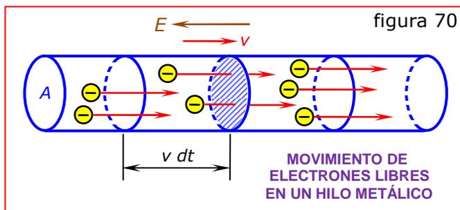
La *figura 70* representa una porción de un *hilo metálico* en el cual hay un *campo eléctrico* hacia la *izquierda* y, consecuentemente, un *movimiento de electrones libres* hacia la *derecha*. Suponemos que cada electrón se
