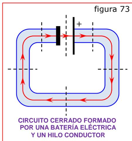
La *línea* marcada con *flechas* indica el *sentido convencional* de la *corriente*. Los *electrones* circulan en el hilo en *sentido contrario*. Los *iones positivos* se mueven, dentro de la batería, en el *mismo sentido* que el *convencional*, y los *iones negativos*, en el *sentido opuesto*.
