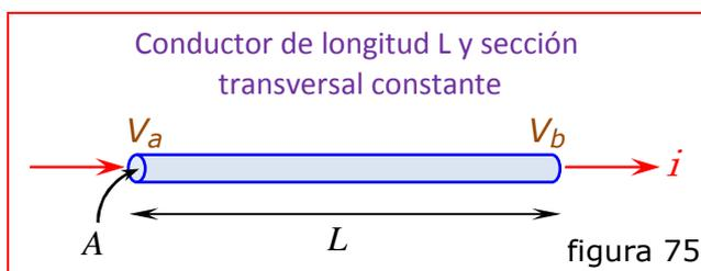
Consideremos un conductor de longitud  $L$  y sección constante  $A$  (figura 75) por el cual circula una corriente de intensidad  $i$ . Sean  $V_a$  y  $V_b$  los potenciales en sus extremos. Limitaremos el estudio a sustancias para las cuales  $\sigma$  es independiente
