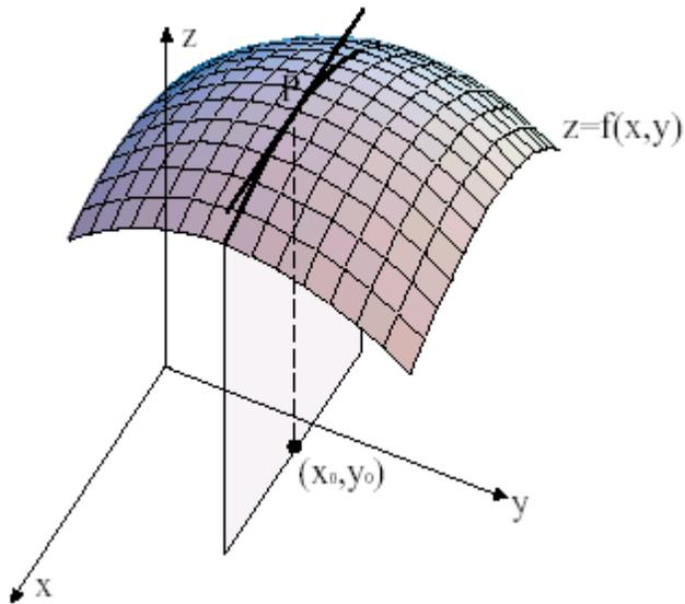
De manera semejante el plano vertical  $x = x_0$  cruza a la superficie  $S$  en una curva de ecuación  $z=f(x_0; y)$  que representa una traza de  $S$  en el Plano  $x_0$ . Ya que la curva es la intersección del plano  $x = x_0$  con la superficie  $S$ . Por lo tanto  $f_y(x_0; y_0)$  es la pendiente de la recta tangente a la curva representada por ambas ecuaciones.
