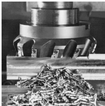
FIGURA 24.5 Cortador de fresado de careado con insertos indexables. Fuente: Cortesía de Ingersoll Cutting Tool Company.
