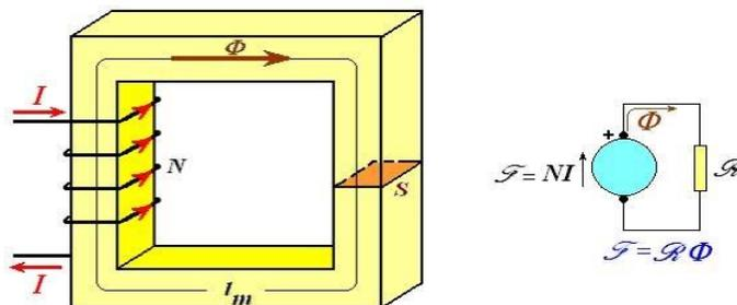
En la imagen vemos un circuito de flujo magnético generado por una fuerza magnetomotriz (Amp vuelta) que debe circular por la longitud del núcleo ( $l_m$ ) a través de la sección del
