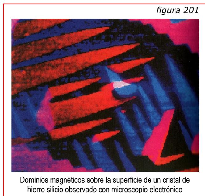
En la [figura 201](#), se muestran dominios magnéticos sobre la superficie de un cristal de hierro silicio observado mediante un microscopio electrónico de barrido con análisis de polarización. Cada color indica una orientación determinada de los dominios.
