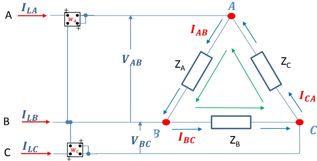
$$W_A = V_{AB} I_{AB} \cos \phi_{AB}^{AB} + V_{AB} I_{AC} \cos \phi_{AC}^{AB}$$
