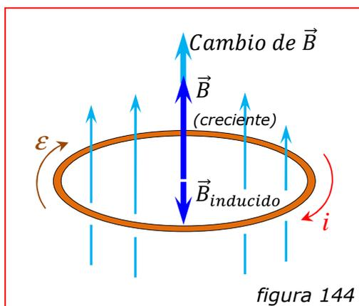
Si la fem es producida por la variación del flujo magnético que atraviesa un circuito cerrado, la corriente resultante de dicha fem es de sentido tal que crea un flujo propio dentro del área limitada por el circuito, que:
