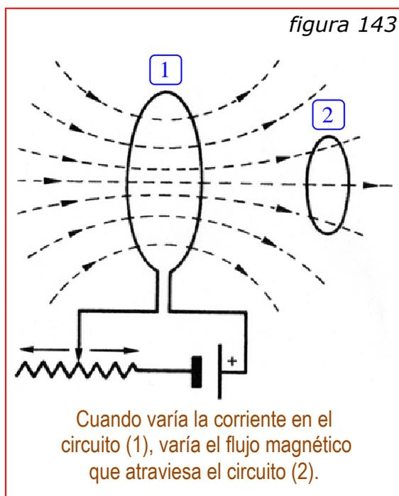
Supongamos, por ejemplo, que dos espiras de hilo conductor están colocadas como se indica en la figura 143. Una corriente que circula por el circuito 1 crea un campo magnético cuyo valor en todos los puntos es proporcional a esta corriente. Una parte de este flujo pasa a través del circuito 2. Si la corriente en el circuito 1 aumenta o disminuye, el flujo a través del circuito 2 variará también.
