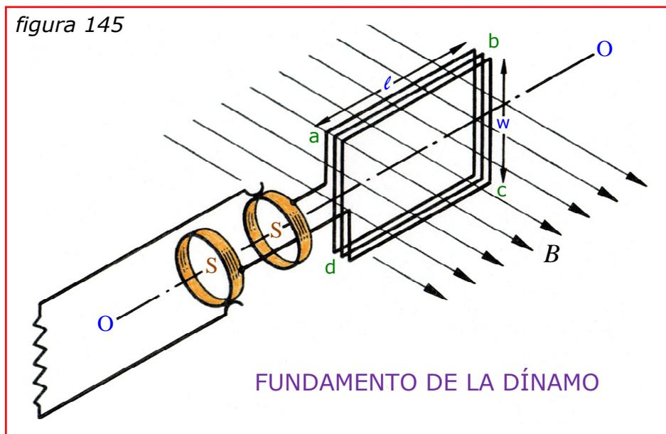
En el instante en que el *plano de la bobina* forma un ángulo  $\alpha$  con la *normal al campo*, como se observa en la *figura 146*, el *flujo* que atraviesa el cuadro es:
