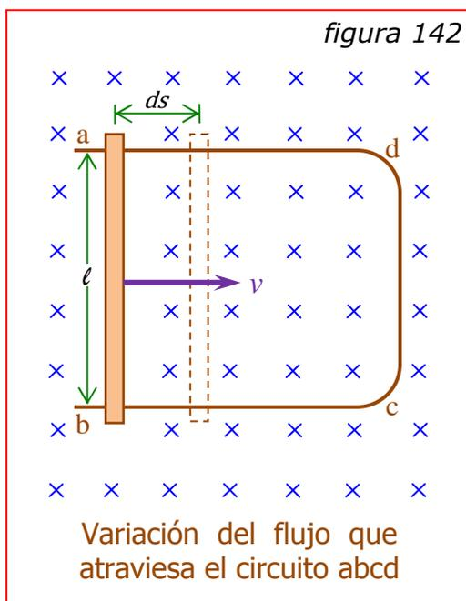
La *fem inducida* en el circuito de la *figura 139* puede considerarse desde otro punto de vista. Mientras el conductor se ha movido hacia la derecha una *distancia ds* (*figura 142*), el *área* abarcada por el *circuito cerrado abcd* ha disminuido en  $dA = l ds$  y la *variación del flujo magnético* que atraviesa la superficie limitada por el circuito es:
