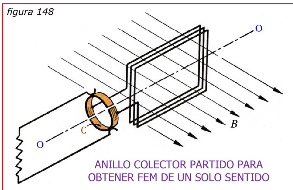
Puede obtenerse fem de *un solo sentido* conectando cada terminal del cuadro a la mitad de un *anillo partido* llamado *colector* o *conmutador*, tal como se representa en la *figura 148*.
