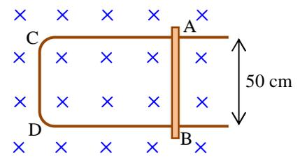
a)  $\varepsilon = B l v = 0,5 \text{ T} \times 0,5 \text{ m} \times 4 \text{ m/s} = 1 \text{ V}$
