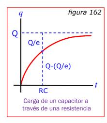
La figura 162 es la representación gráfica de esta ecuación. La carga se aproxima asintóticamente a su valor final y se requiere un tiempo infinito para que el condensador quede completamente cargado. La constante de tiempo del circuito es igual a RC, siendo ésta el tiempo necesario para que la carga del capacitor aumente hasta el 63 % de Q.
