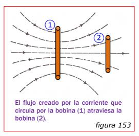
Hemos visto que en un circuito fijo se induce una fem cuando aumenta o disminuye el flujo magnético ligado al circuito. Si la variación de flujo es producida por una corriente variable que circula en un segundo circuito, es cómodo expresar la fem inducida en función de esta corriente variable, en vez de utilizar la variación de flujo.
