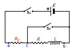
alcanzado su valor estable final, ¿cuáles son los valores de i,  $V_{ac}$  y  $V_{cb}$ ? c) Determinar las expresiones de i,  $V_{ac}$  y  $V_{cb}$  en función del tiempo t, a partir del momento en que se cerró  $s_1$ . Sus resultados deben concordar con el inciso a) cuando t=0 y con el inciso b) cuando  $t\to\infty$ .
