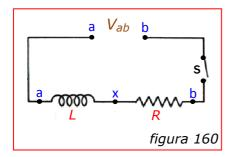
Cuando se cierra el interruptor de la *figura 160*, la *corriente* en el circuito *aumenta* desde *cero* hasta un *valor final*  $V_{ab}/R$ . En el *instante* en que la corriente es i y <u>crece</u> en la proporción di/dt, tenemos:  $V_{ab} = V_{ax} + V_{xb} = L \frac{di}{dt} + R i$
