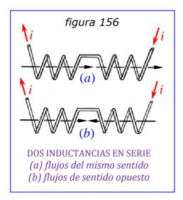
la inductancia mutua es M y se encuentran conectadas en serie. Supongamos que estas bobinas están colocadas como se indica en la figura 156a, de modo que el flujo que atraviesa cada una, debido a la corriente que circula por la otra, tiene la misma dirección que el flujo debido a la corriente de la propia bobina. Entonces, si la corriente varía, ambas fuerzas electromotrices, de autoinducción y de inducción mutua, tendrán el mismo sentido:
