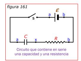
Cuando se cierra el interruptor s de la figura 161, la carga del capacitor no aumenta instantáneamente hasta su valor final, sino que tiende hacia ese valor del mismo modo que lo hace la intensidad de la corriente en un circuito que contiene inductancia y resistencia.
