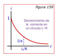
Si hay una corriente constante I en el circuito de la figura 157 y cerramos el <u>interruptor</u>  $S_2$  (abriendo simultáneamente el  $S_1$  para desconectar la fuente y evitar dañar la misma), la corriente no se reduce instantáneamente a cero, sino que decrece gradualmente tal como se representa en la figura 159, cuya curva es exactamente la inversa de la correspondiente a la figura 158. La <u>ecuación</u> de
