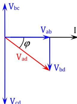
**Ejercicio N° 118:** Una resistencia de  $400 \Omega$  está en serie con una autoinducción de  $0,1 H$  y un condensador de  $0,5 \mu F$ . Calcular la impedancia del circuito y dibujar el diagrama del vector impedancia: a) a la frecuencia de  $500 Hz$ ; b) a la frecuencia de  $1.000 Hz$ . Hallar, en cada caso, la diferencia de fase entre la intensidad de la corriente y el voltaje en la línea, especificando si la intensidad de la corriente está atrasada o adelantada.
