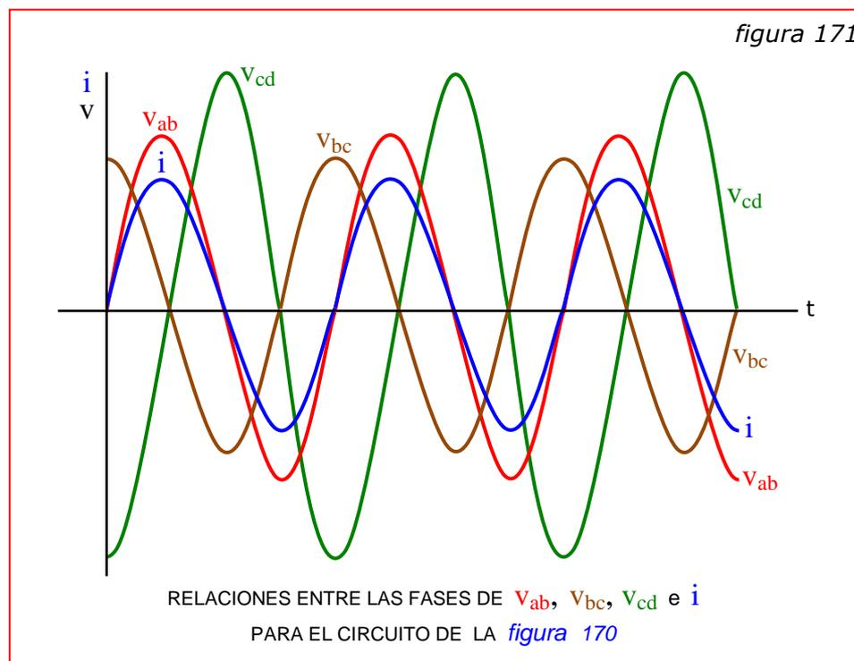
En la figura 171, la línea azul representa la corriente instantánea, que es la misma en todas las partes del circuito y que tiene un valor máximo de  $5\sqrt{2} \text{ A}$ . Las otras tres curvas representan las tensiones instantáneas entre  $a$  y  $b$  (línea roja),  $b$  y  $c$  (línea
