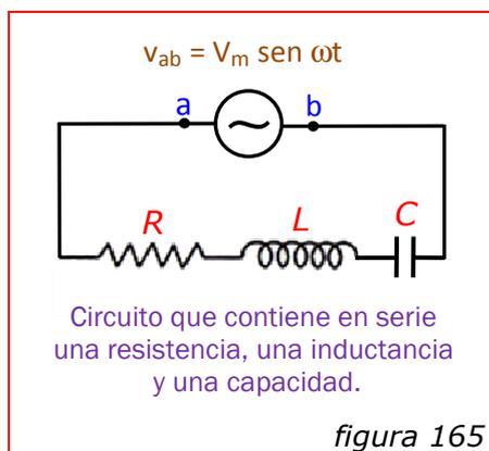
Sea un circuito constituido por una resistencia, una inductancia y un capacitor, conectados en serie entre los bornes de un alternador, como se representa en la figura 165. La diferencia de potencial instantánea entre a y b es la suma de las diferencias de potencial instantáneas entre los bornes de R, L y C. Es decir:
