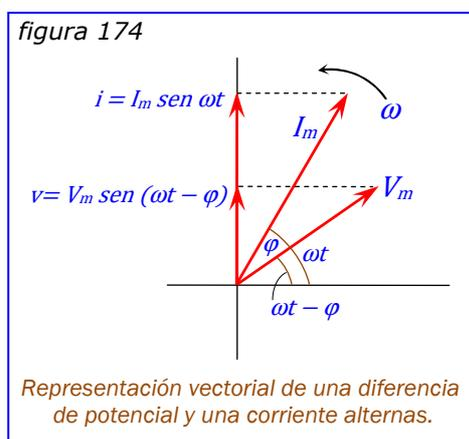
gira. Este método es equivalente al que se utiliza para representar un movimiento armónico simple, proyectando un punto que se mueve en una circunferencia con velocidad angular constante, sobre un diámetro de la misma circunferencia.
