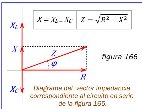
sobre el eje Y, siendo sus *sentidos positivo y negativo*, respectivamente. La *impedancia* es el *vector suma geométrica* o *resultante* de estos *tres vectores*, según se representa en la *figura 166*, denominada *diagrama del vector impedancia del circuito*. Esta figura se ha dibujado para el caso  $X_L > X_C$  y por ello  $X$  es positiva.
