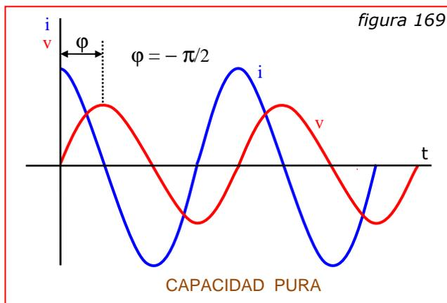
corriente está adelantada respecto a la tensión un ángulo de  $\pi/2$  radianes o de  $90^\circ$ , según se indica en la [figura 169](#).
