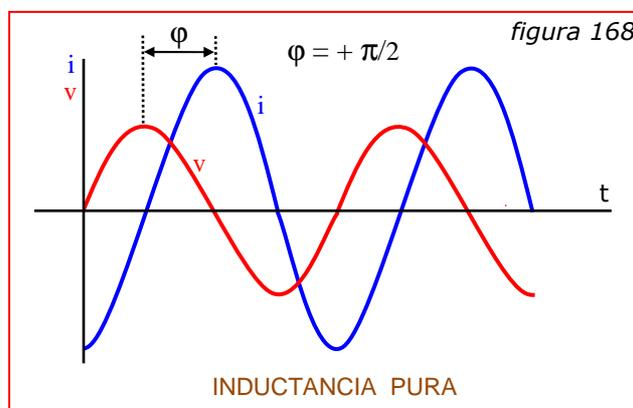
Si el circuito se compone de una inductancia pura,  $R = 0$ ,  $Z = X_L$ ,  $\varphi = +\pi/2$  y la corriente está atrasada respecto a la tensión un ángulo de  $\pi/2$  radianes o de  $90^\circ$ ,
