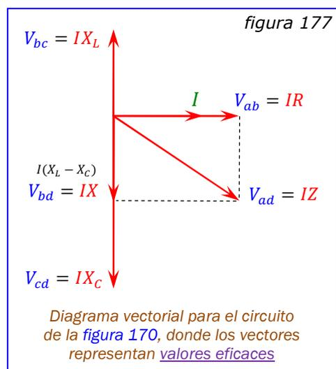
diferencia de potencial instantánea entre los extremos  $a$  y  $d$  del circuito. Además, el ángulo phi entre el fasor resultante  $V_{mad}$  y el fasor  $I_m$  de la corriente, indicará la diferencia de fase del circuito en conjunto.
