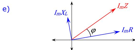
**Ejercicio N° 116:** Una autoinducción de reactancia  $10 \Omega$  y un condensador de reactancia  $25 \Omega$  (medidas a  $60 \text{ c/s}$ ) se encuentran conectados en serie con una resistencia de  $10 \Omega$  a una línea de corriente alterna de  $60 \text{ Hz}$  y diferencia de potencial eficaz  $100 V$ . Calcular: a) el voltaje entre los bornes de cada parte del circuito; b) las expresiones del voltaje y de la intensidad instantánea en la línea.
