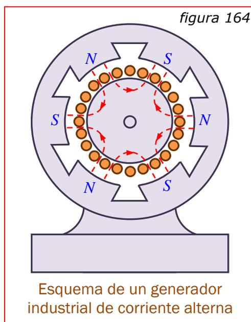
Este sencillo dispositivo es el prototipo de los generadores industriales de corriente alterna, llamados *alternadores*.
