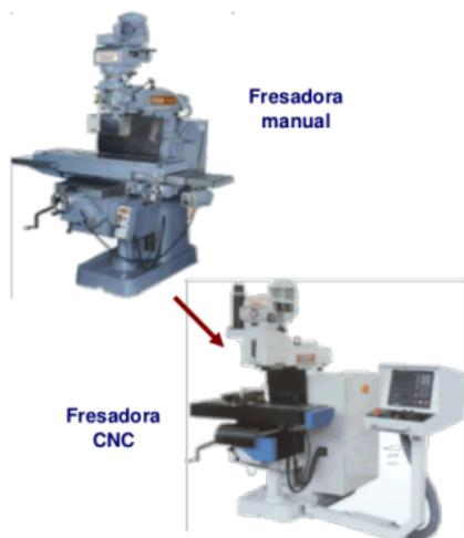
La introducción del CNC en las MH no cambia la arquitectura, estructura, funciones, etc. El único cambio es que el movimiento de los ejes se puede programar.
