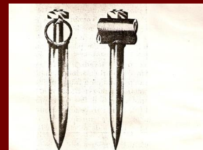
Representación de un método de sujetar los picos a las barras portadientes. (J. I. Case Co.)
