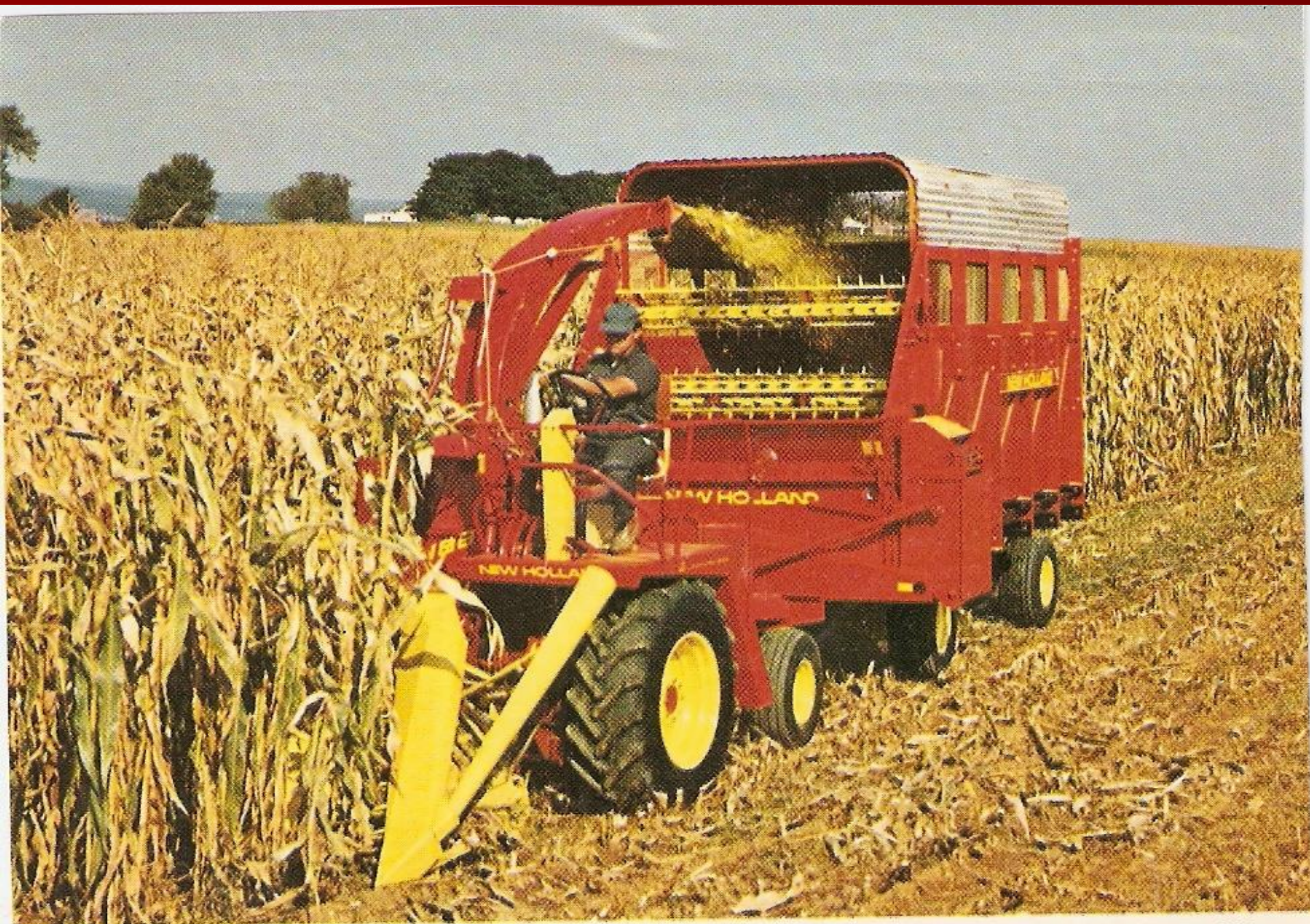
La cosechadora de forraje automotriz Crop-Cruiser® Modelo 1880 puede ser equipada con mando hidrostático. Con este sistema se evitan los cambios mecánicos bajo condiciones normales.
