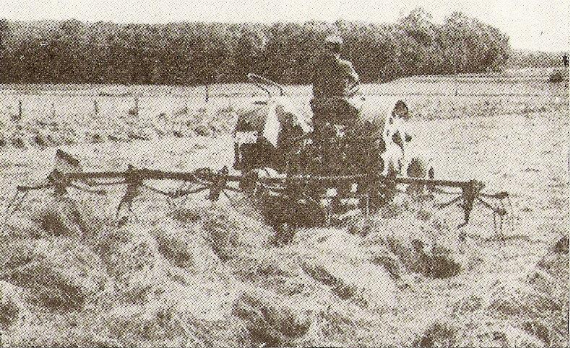
Fig. 239. Labor que realiza una henficadora de molinetes verticales. (Cliché: Bonnet et Fils.)
