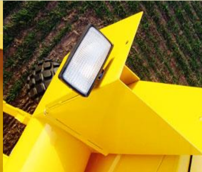
Luces de posición, indicadores de giro, stop y reflector en tubo descarga.
