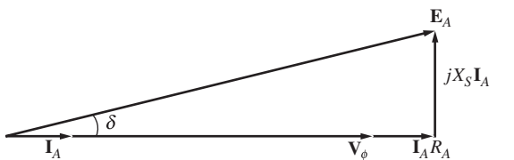
FIGURA 4-13 Diagrama fasorial de un generador síncrono con un factor de potencia unitario.
