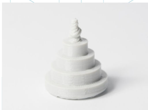
Figura 52: Impresión de pines verticales disminuyendo el diámetro (de 25 a 5 mm), mostrando que el diámetro superior de la impresión se vuelve muy pequeño para imprimir con precisión. [77]
