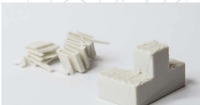
Figura 48: Pieza de puzle impresa por FDM con los soportes retirados, mostrando la aspereza de la superficie. [73]
