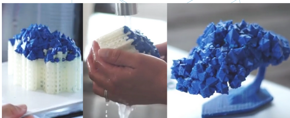
Figura 35: Baño para quitar las estructuras de soporte. [51]
