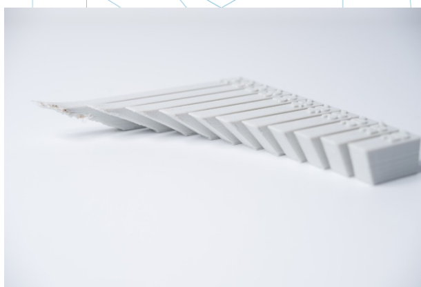
Figura 50: El efecto de incrementar el ángulo de voladizo (incrementos de 5 grados) en la calidad de impresión. El ángulo máximo mostrado es de 70 grados. [75]
