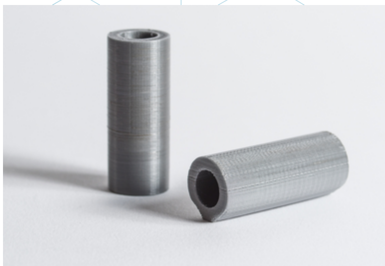
Figura 24: Diferencias de calidad en una misma pieza, dependiendo de su orientación. [40]
