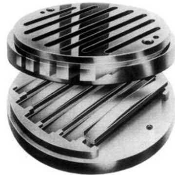
Figura 2.8. Válvulas típicas de compresor recíprocante
