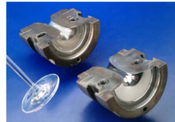
Molde para el pie de una copa: La superficie de los moldes se pulen manualmente hasta obtener un "acabado espejo" que garantiza la estética de las piezas
