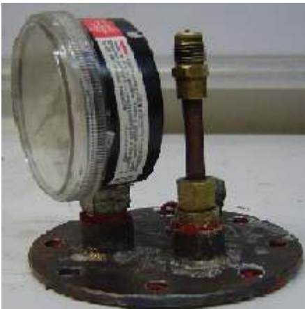
Figura 31. Manómetro y Válvula de carga
