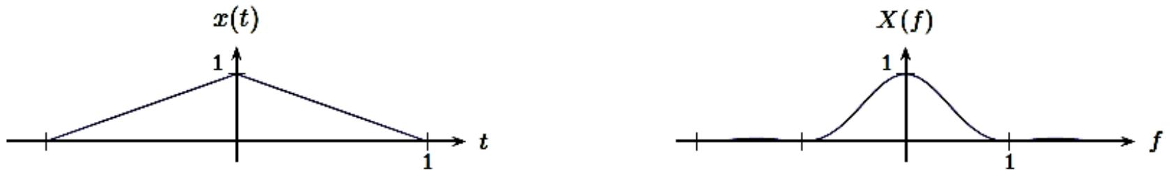
Figura 2.9: Transformada de Fourier de pulso triangular
