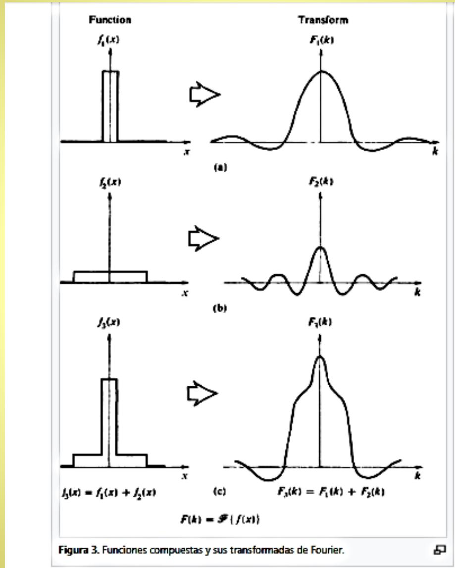
Figura 3. Funciones compuestas y sus transformadas de Fourier.
