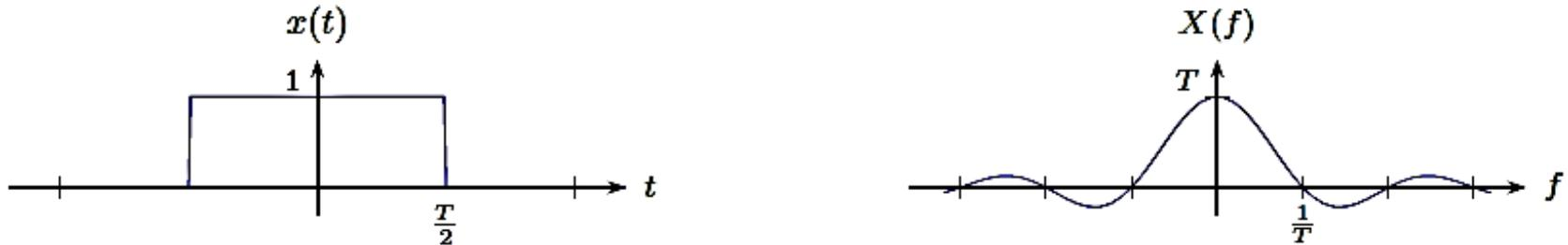
Figura 2.6: Transformada de Fourier de un pulso rectangular
