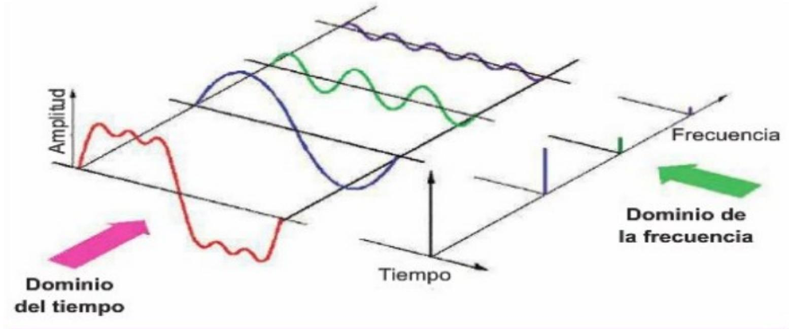
*Señal periódica compuesta y sus armónicos sinusoidales representados en el dominio del tiempo y en frecuencia.*
