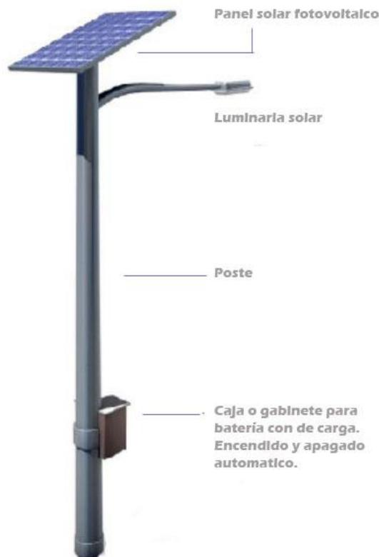
*Figura nº 141 Luminaria solar fotovoltaica autónoma*
