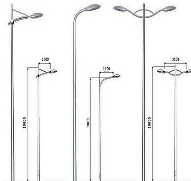
*Figura nº 142 Diferentes tamaños y diseño de postes solares*
