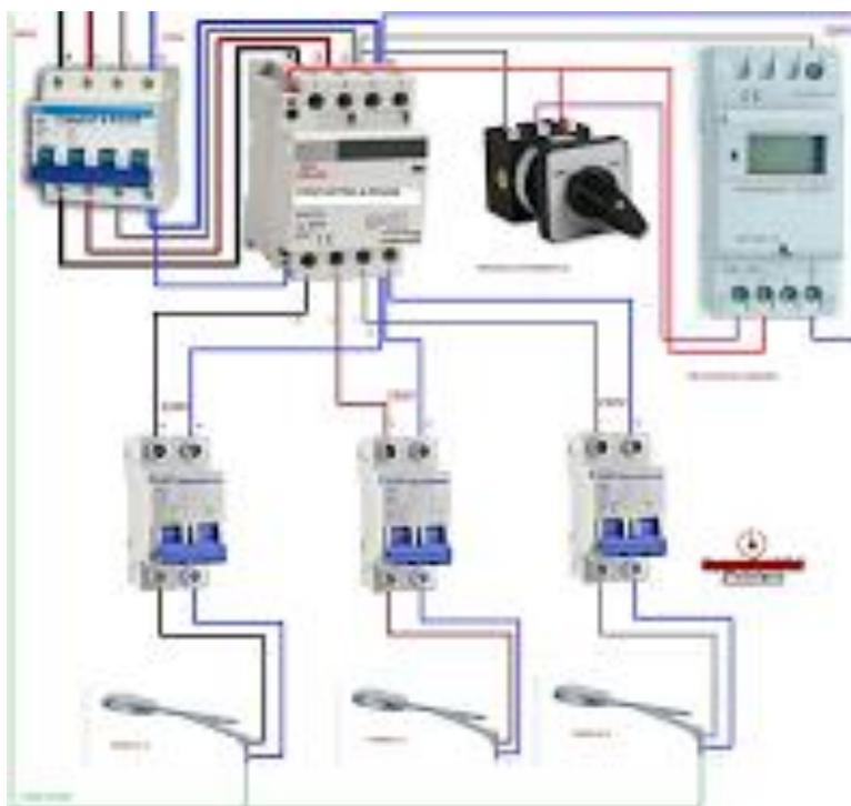
Figura nº 83 Diagrama de conexión del reloj astronómico
