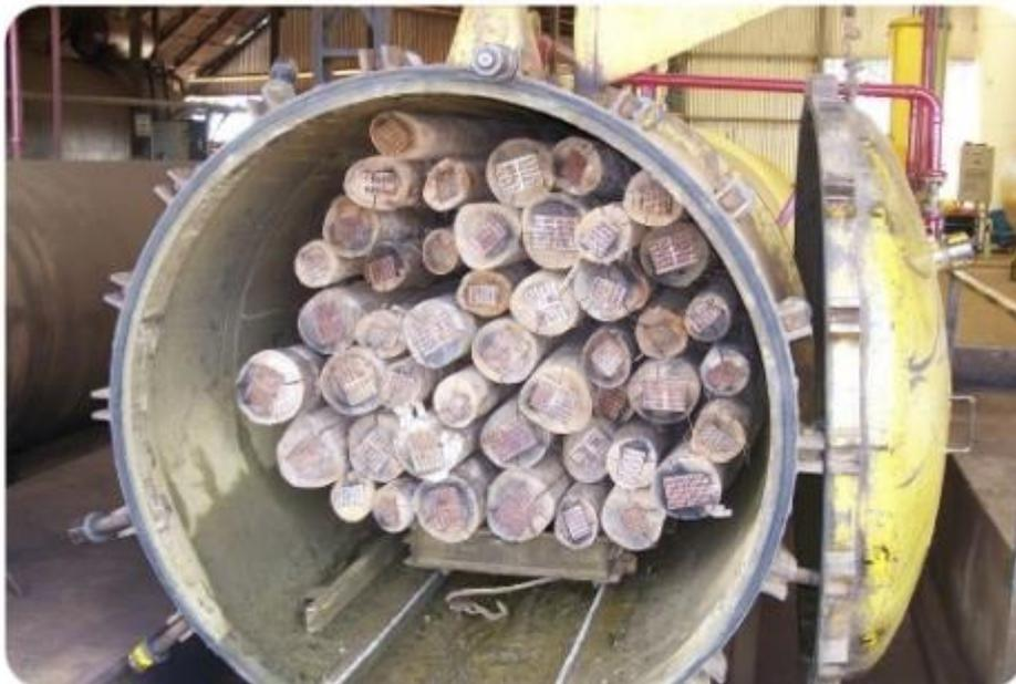
*Figura nº 86 Autoclave para tratamiento de postes de maderas*
