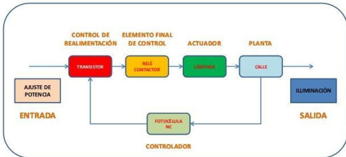
Sistema de iluminación de las calles en donde con la luz solar se activa o desactiva la fotocélula, permitiendo la entrada de energía, activando los componentes de la luminaria, haciendo que se encienda el bombillo. Las perturbaciones pueden ocasionarse por las luces de los vehículos y otras luces que pueden influir en la activación o desactivación de la fotocélula.
