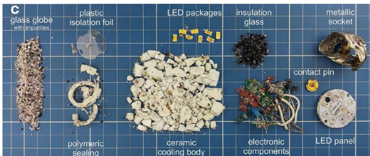
Figura nº 175 Fracciones obtenida de los distintos componentes de una lámpara led
