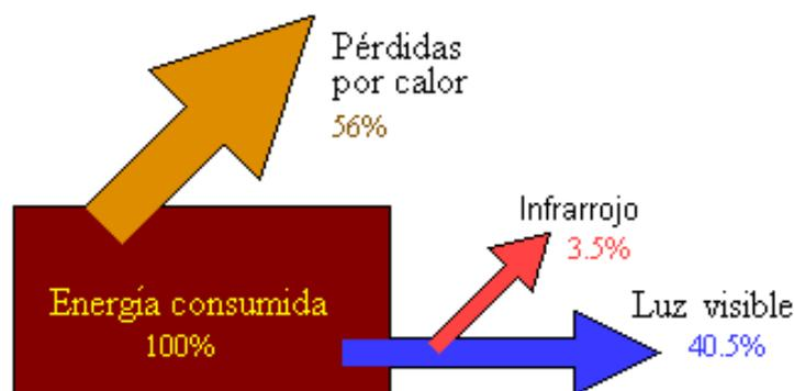
Figura nº 129 Rendimiento en lámpara vapor de sodio de alta presión
