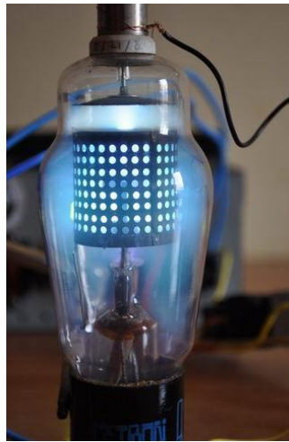
Figura 1.2 Thyatrón en funcionamiento, se puede apreciar el fenómeno De la ionización gaseosa
