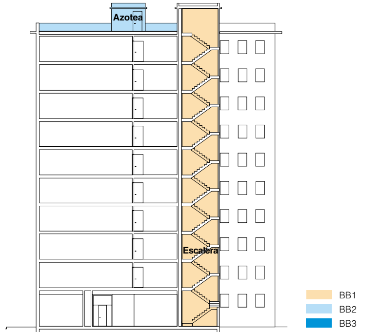
Fig. G8-020: zonas en función de la humedad en los servicios generales de las plantas, vista vertical.
